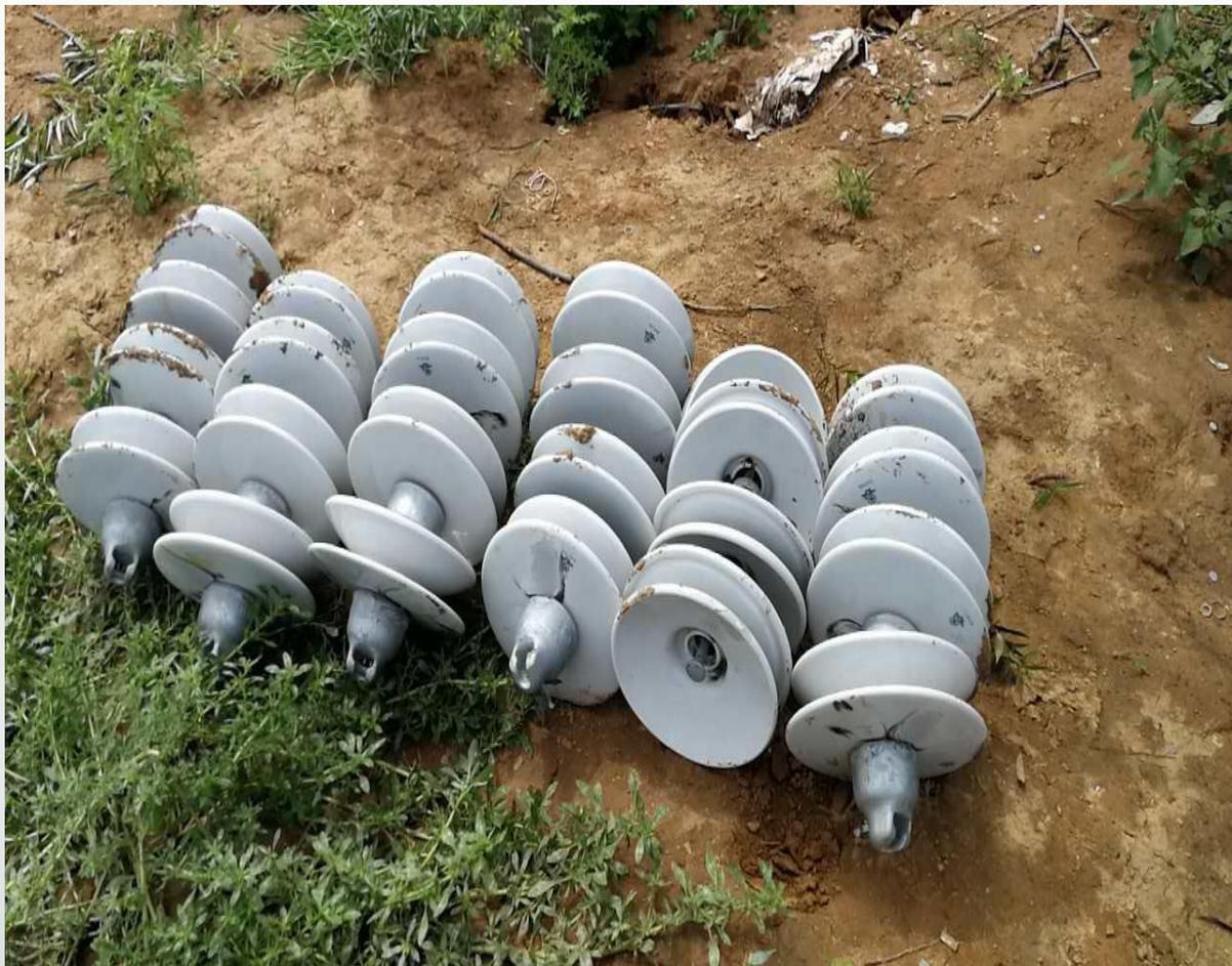
2017年5月，山西某30MW运行项目发生35KV母线失压，集电I线、II线发电设备停运，#1接地变停运，全站厂用电失电故障。经事后调查，事故原因为杆塔塔顶绝缘子雷击受损爆裂，引发保护开关联动跳闸，连带集电线保护停运，发电量损失超过60万元。
