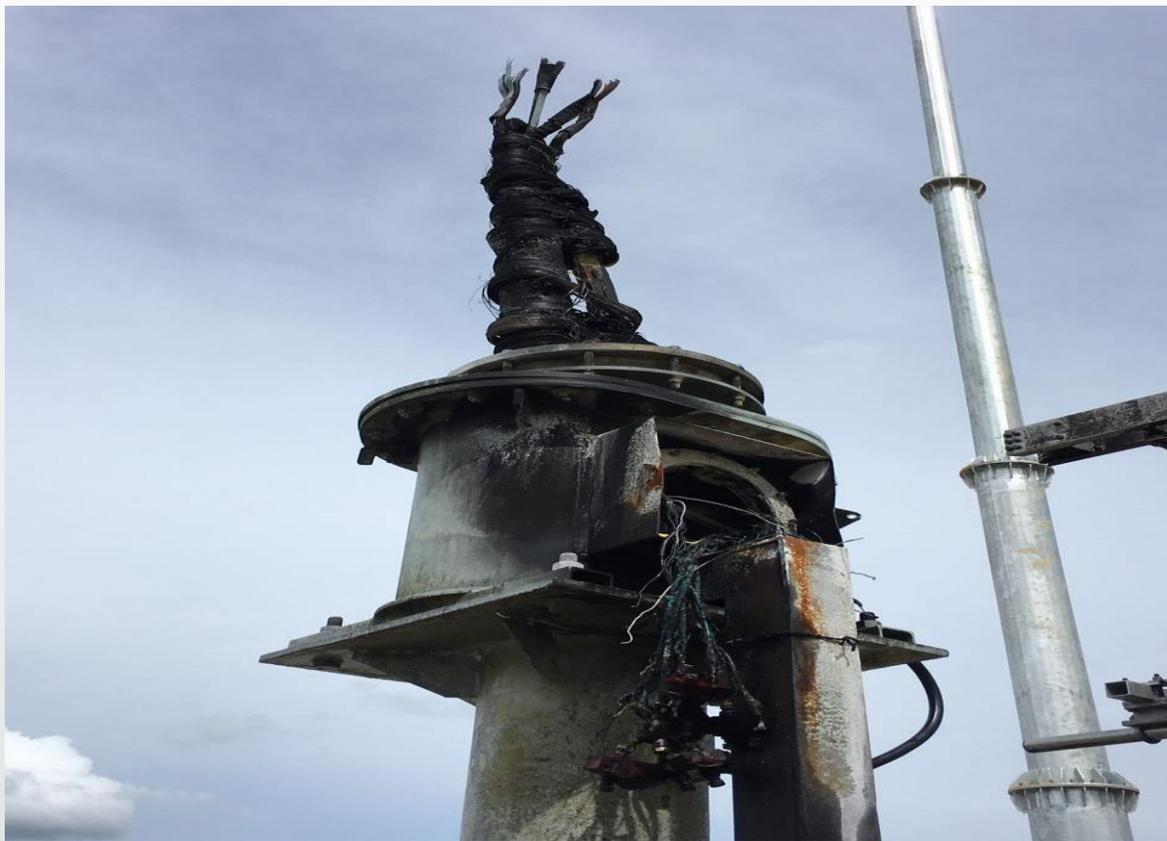
2017年6月，广东某30MW运行项目在检修送电过程中，电流互感器在设备充电时发生C相爆炸事故，并引发电气火灾，造成升压站内开关、刀闸、电压互感器、避雷器设备瓷套不同程度损坏，全厂停运。直接损失超过70万元，发电量损失超过100万元。
