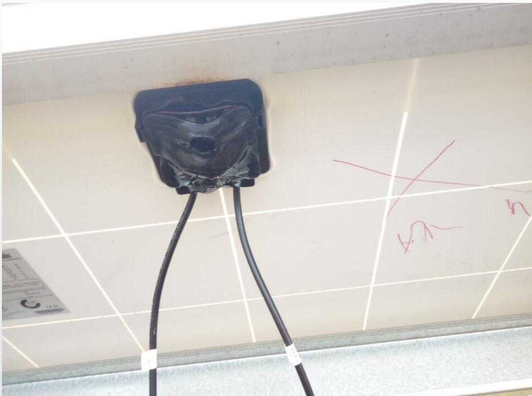
2016年7月，海南某30MW在建项目发生大面积组件雷击事故，全厂受损组件接近1000片，背板接线盒大量烧毁，电池片引出线短路，组件开路电压基本无输出，直接经济损失超过80万元，发电量损失超过30万元。
